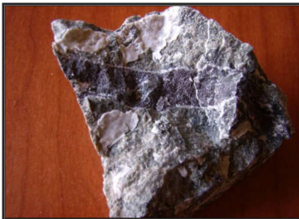
Slika 6.4. Makroskopski izgled rude iz ležišta „Kraku Bugaresku – Cementacija“ (cementacioni halkozin - tamno plavo, u silifikovanoj i kaolinisnoj osnovnoj masi stene - svetlo sivo).
